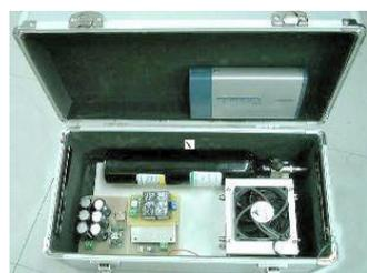
図4 搭載した燃料電池
