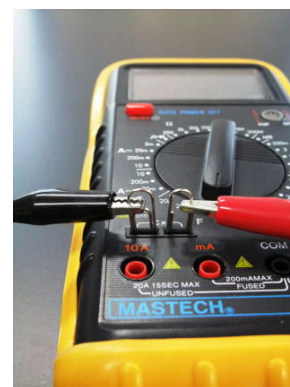
図 クリップ付導線の接続方法
