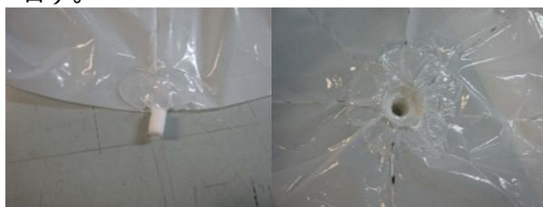
図3 キャップの貼り付け
