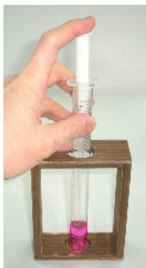
図2 0.1mol/L水酸化ナトリウム標準溶液の滴下
