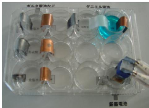
図2 金属や試薬のセットの様子(拡大)
