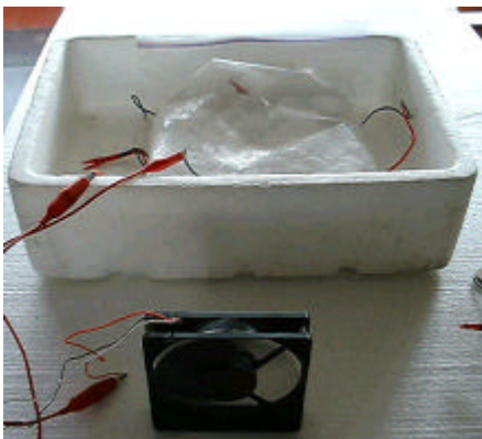
図2 雪を使った温度差発電により回転するファン
