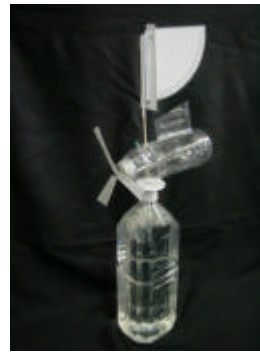
図14 簡易風力発電装置
