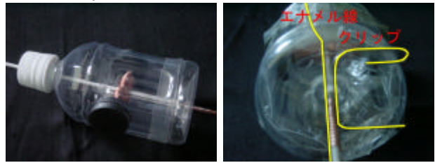
図22 磁石の取付け 図23 ブラシの取付け (9) ブラシとなるクリップとエナメル線に電池をつなぎ、プラスチック棒を指で回してはずみをつける。
