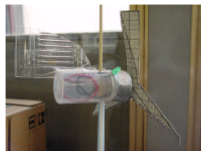
図4 風力発電装置機（発光ダイオード付）
