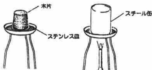
図2 簡易製炭装置
