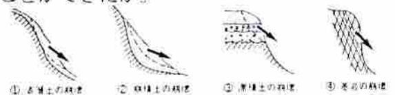
図7 斜面崩落のパターンA
