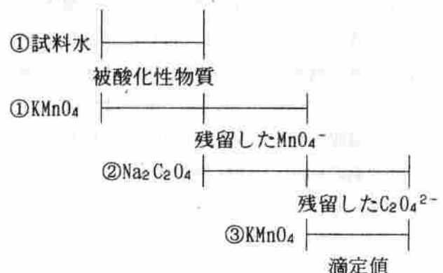
図1 試料水， \text{KMnO}_4 ， \text{Na}_2\text{C}_2\text{O}_4 の量的関係
