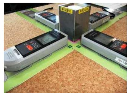
図4 遮蔽物の厚さの違いによる放射線の測定
