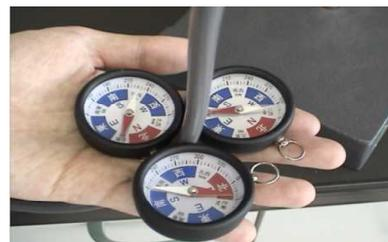
図4 電流による磁界
