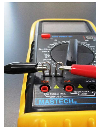
図 クリップ付導線の接続方法
