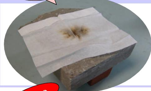
岩石の熱伝導率を調べる実験です。凝灰岩は熱を通しにくい性質があるため、加熱した部分と反対側の温度差が大きいことがわかります。
