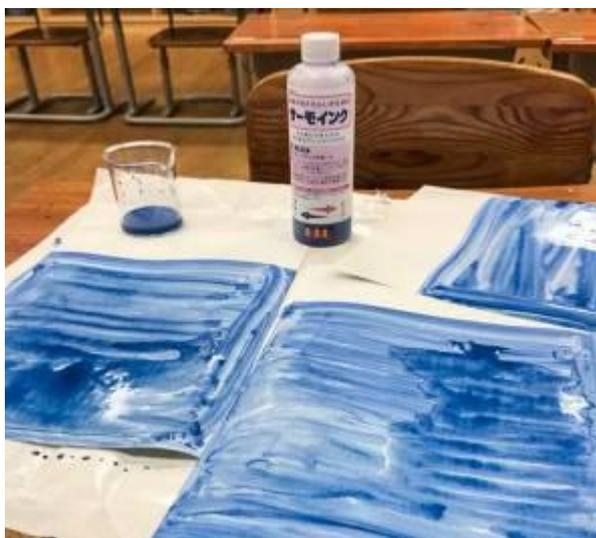
図1 示温インクを塗布し乾燥している様子
