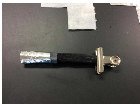
図3 アルミニウムはくを木炭電池に巻きつける様子
