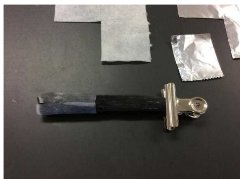
図2 キッチンペーパーを木炭電池に巻きつける様子
