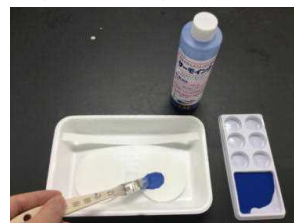
図2 示温インクをろ紙に塗る様子
