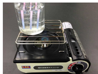
図8 ラミネート加工した示温ペーパーを水の中に入れている様子
