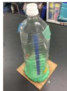
図12 ペットボトルの内側にラミネート加工した、示温ペーパーを貼った様子
