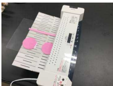
図5 ラミネーターでラミネートする様子
