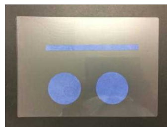
図4 示温インクを染み込ませたろ紙をラミネートフィルムで挟む様子
