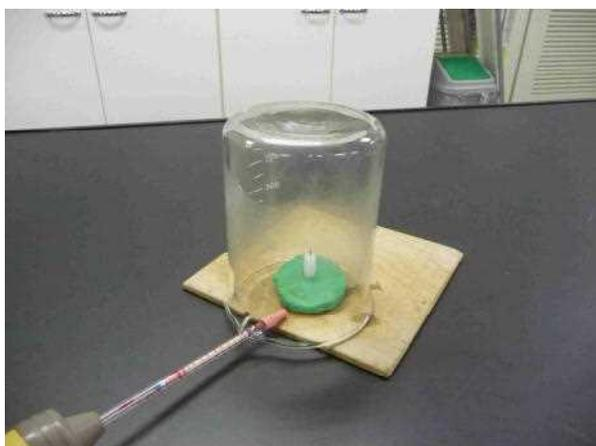
図4 気体検知管を用いた測定
