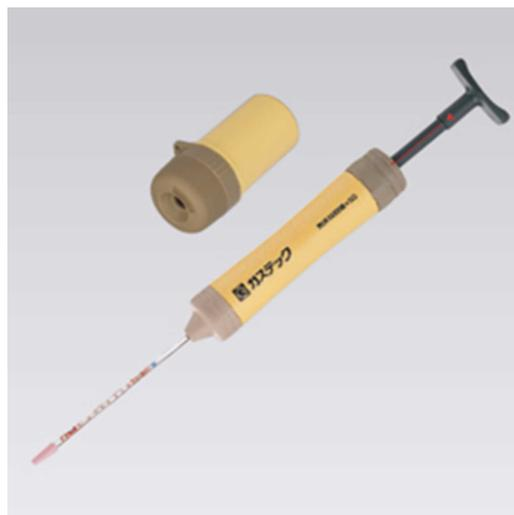
図1 気体検知管（左下）と測定器
