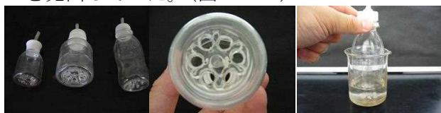
図3, 4, 5 ペットボトルをビーカーに出し入れすることで、気体が発生するタイミングと量を調節する
