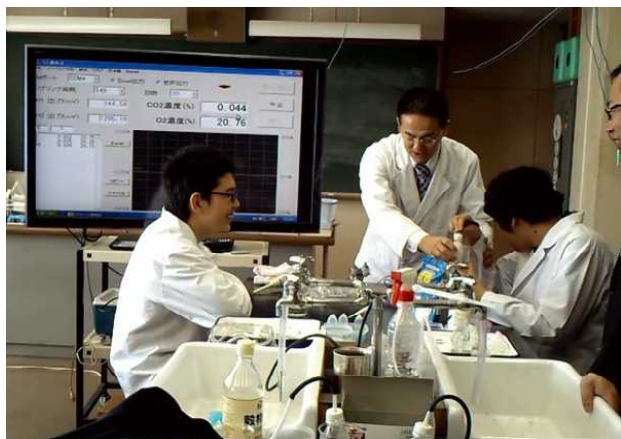
図3, 4, 5 ペットボトルをビーカーに出し入れすることで、気体が発生するタイミングと量を調節する
