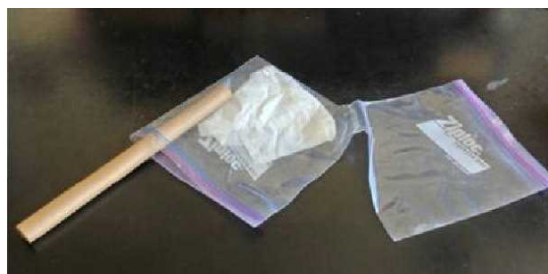
図1 フリーザーバッグを利用した実験装置 (左の紙筒から息を吹き込み、右のフリーザーバッグ内にセンサを入れる)
