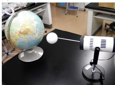
図2 実験で使った光源、ボール、地球儀
