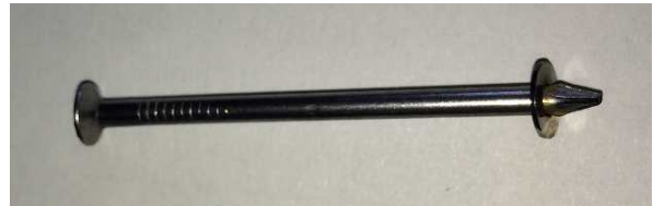
図11 ワッシャーの加熱前には通らなかった釘が、加熱後には通り、ワッシャーの冷却により、外れなくなる
