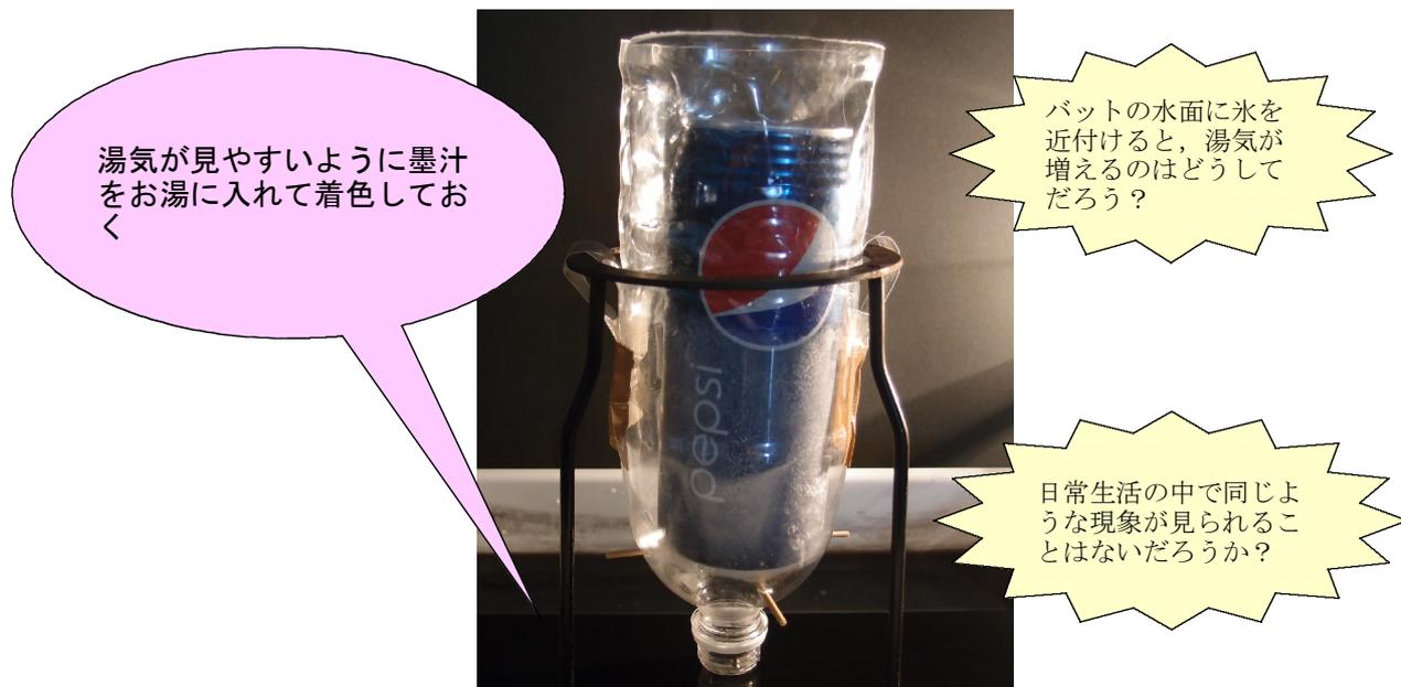
3 底を切り取ったペットボトルを逆さまにして三脚に立て、その中に竹串を十字にして装着し、氷と食塩を入れたアルミニウム缶を入れて湯気の出方を観察する。
